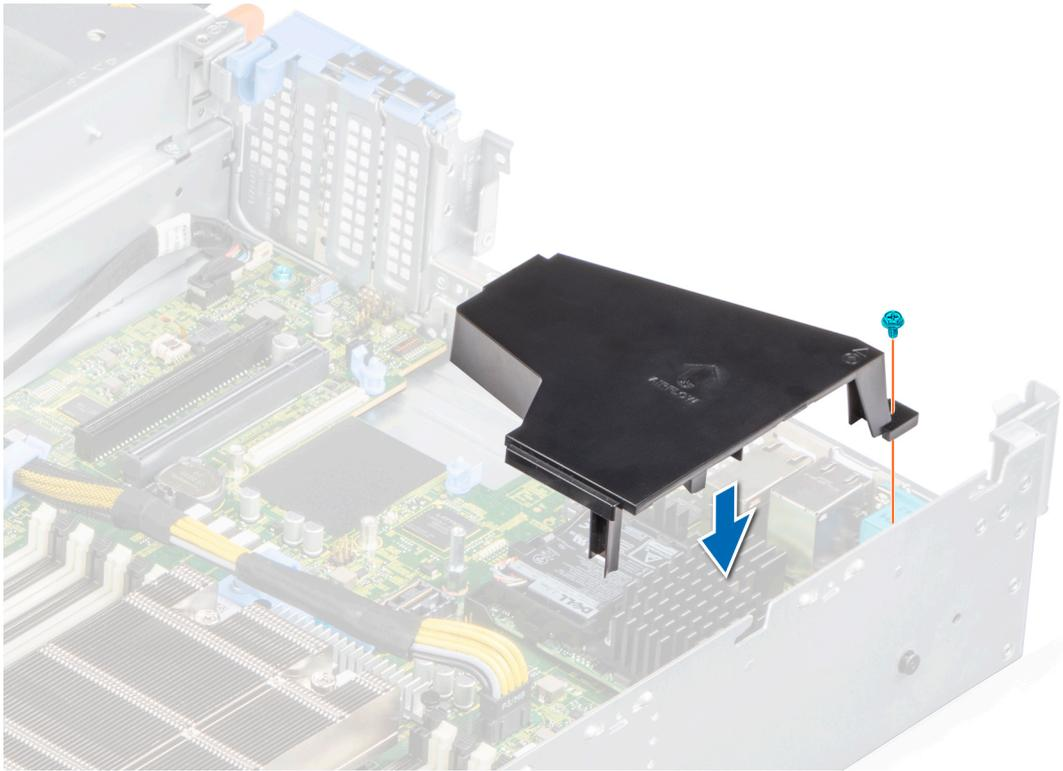
**Figure 107. Installing the mini PERC card air shroud**
