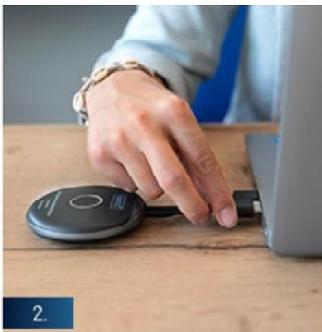
Collegare il trasmettitore alla porta USB e HDMI del proprio PC. Il trasmettitore e ricevitore creano automaticamente il collegamento.
