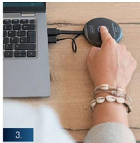
Poi premere il tasto di collegamento sul trasmettitore per iniziare il trasferimento dei contenuti dello schermo.
