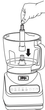
**3** Placez le mandrin de disque sur l'engrenage de disque à l'intérieur du bol.
