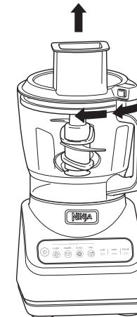
**5** Mettez le couvercle de la goulotte d'alimentation sur le bol et tournez dans le sens des aiguilles d'une montre jusqu'au déclic qui indique que le couvercle est verrouillé.
