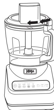
**5** Plaats het deksel met de vultrechter op de kom en draai het rechtsom tot u een klik hoort; dit geeft aan dat het deksel is vergrendeld.
