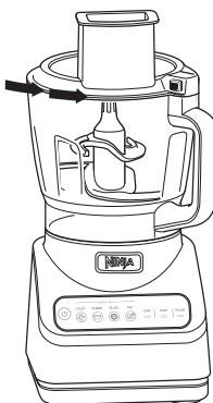
**7** Druk na afloop op de knop op het deksel met de vultrechter, vlakbij het handvat, om het deksel te ontgrendelen en draai het deksel vervolgens naar links. Haal het deksel van de kom. Verwijder altijd de hakmessenset alvorens de ingrediënten uit de kom te halen. Verwijder de hakmessenset door de bovenkant van de stang voorzichtig vast te pakken en uit de kom te tillen.
