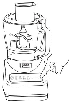
**6a** Sluit het apparaat aan op het stopcontact en druk vervolgens op de aan-/uitknop om hem in te schakelen. Als u een Auto-iQ®-programma gebruikt, selecteer dan eerst het programma dat het best bij uw recept past. De vooraf ingestelde functie zal het apparaat aan het einde van het programma automatisch stoppen. Om het apparaat op elk gewenst moment te stoppen, drukt u nogmaals op het op dat moment actieve programma.
