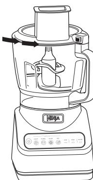
**7** Cuando haya terminado, presione el botón en la tapa con vertedor, situado cerca del mango, para desbloquear la tapa; gírela en sentido antihorario. Levante la tapa del bol. Retire siempre el grupo de cuchillas de picado antes de vaciar los ingredientes en el bol. Para retirar el grupo de cuchillas de picar, tome con cuidado la parte superior del eje y levántelo para sacarla del bol.
