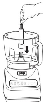
**3** Coloque el adaptador de disco en el engranaje del motor dentro del bol.
