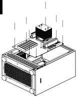
装入I/O弹片,再装 入主机板, 用螺丝 锁固
