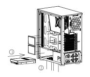
底部可以装一个3.5 HDD;主板背面可以 装2个SSD
