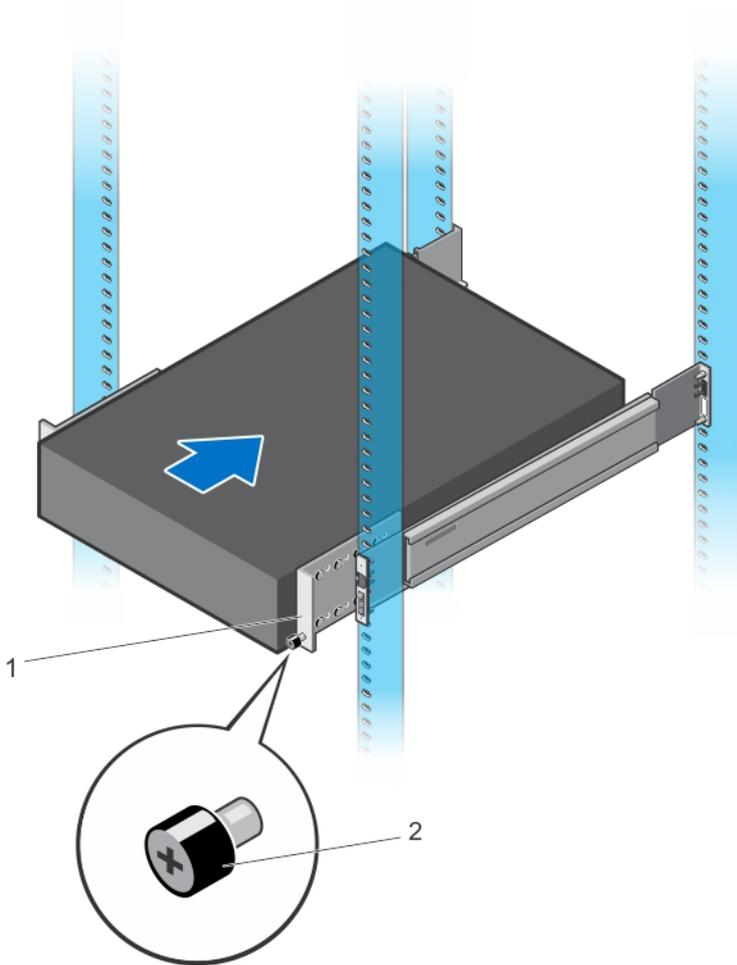
**Figure 18. S5296F-ON installation**
