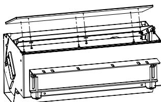
Zur besseren Zugänglichkeit zu den hinteren Schrauben ist die große Klappe mit der Hand ca.  $\frac{3}{4}$  zu schließen. Verwenden Sie hierzu einen Kurz-Schraubendreher.
