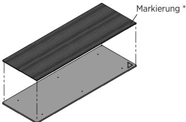
\* dauerhafte Markierung, Vertiefungsfläche für Kennzeichnung der Betätigungen anbringen.
