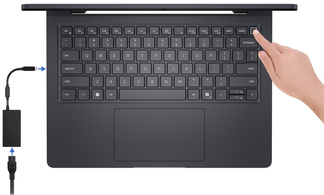
Figur 8. Anslut nätaggregatet och tryck på strömbrytaren
