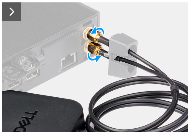
Figur 34. Ta bort extern puckantenn
