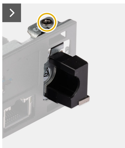
Figur 68. Installera antenmodulen (vit kabel)
