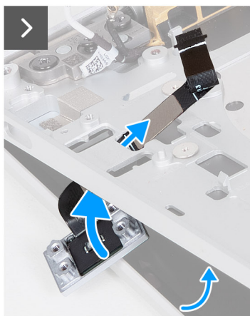
Figur 44. Installera strömbrytaren med fingeravtrycksläsare
