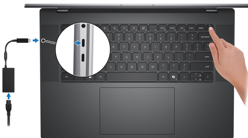
Figur 10. Ansluta nätaggregatet och tryck på strömbrytaren.
