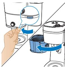
2 Öffnen Sie den Filterhalter, um Zugang zur Trichterschüttte zu erhalten.
