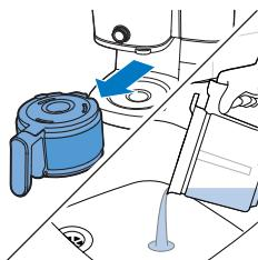
**14** Sürahiyi boşaltın ve kireç kalıntıları bulunan kalıcıfiltreyi çıkarın.
