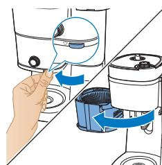
4 Ta tag i fliken för att öppna filterhållaren.
