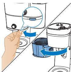
2 Ta tag i fliken för att öppna filterhållaren.
