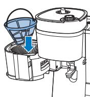
**11** Встановіть фільтр у кошик фільтра.
