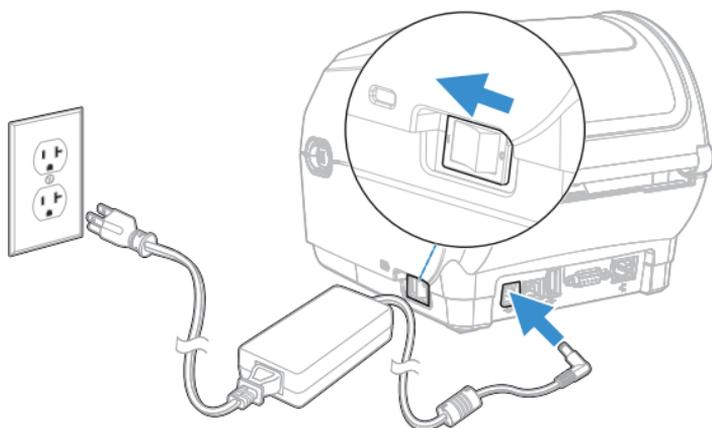
**Nota:** Asegúrese de que el interruptor de alimentación de la impresora esté apagado antes de conectar el cable de alimentación.
